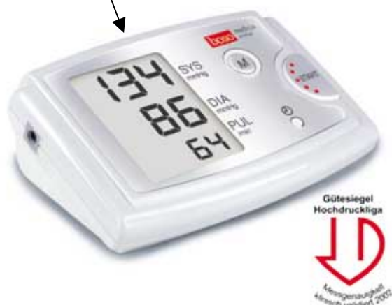
Slika 1: Izgled tlakomjera tip BOSO-MEDICUS PRESTIGE s prikazom mjesta za smještaj ovjerne naljepnice
